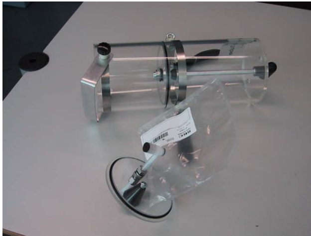
Abbildung 2 Ein Vac-U-Tube mit Tedlar-Beutel
