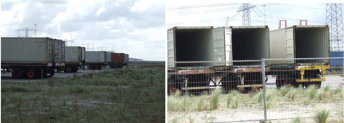
Abbildung 6 Containeraufstellung im Experiment, wobei links die drei Gruppen von jeweils drei Containern gezeigt werden und rechts eine Gruppe von drei geöffneten Containern
