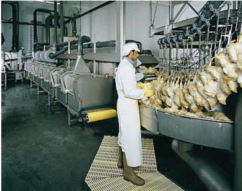
Figuur 4: De kippen komen levenloos uit de installatie en worden daarna pas aangehaakt. Dit gebeurt bij normaal wit licht. Omdat de kippen niet met de vleugels flapperen is het aanhaken relatief stofvrij. Foto gebruikt met permissie van Stork BV.
