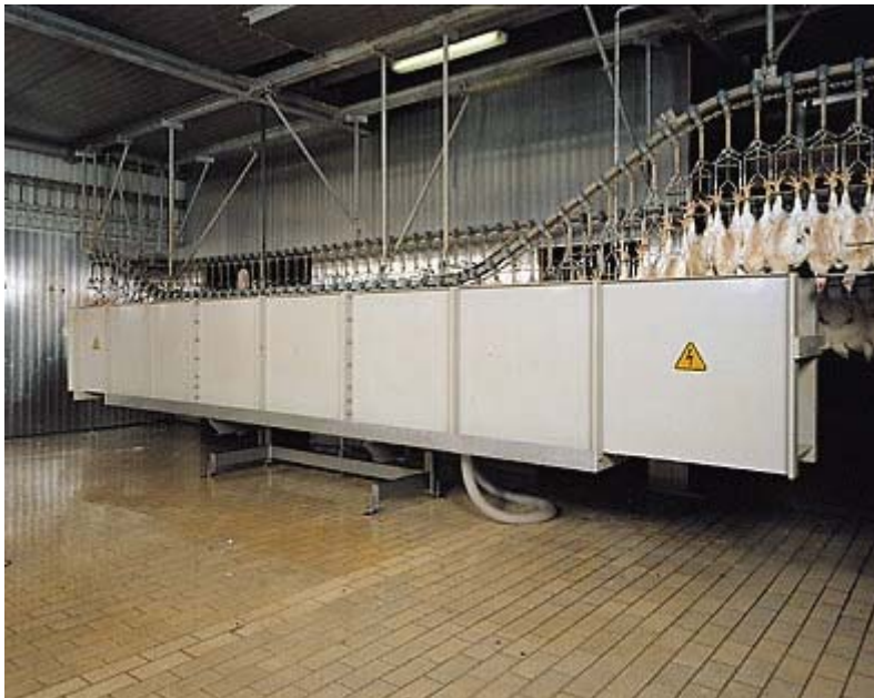
Figuur 3: Andere (hoog-frequentie) uitvoering van een elektrisch waterbadverdoover. Foto gebruikt met permissie van Stork BV.
