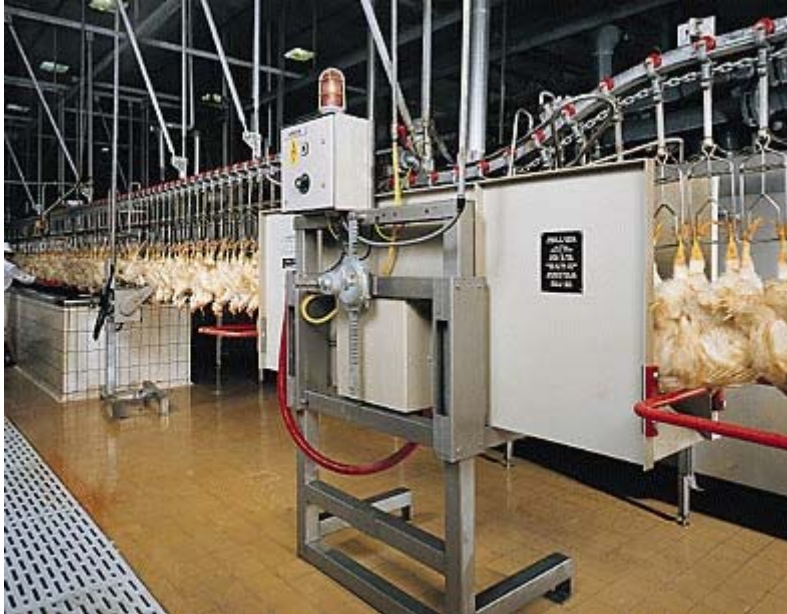
Figuur 2: De kippen worden na het lossen aangehaakt en worden vervolgens door het elektrisch waterbad geleid. Het lossen en aanhaken gebeurt onder blauw licht omdat de kippen daarin niet kunnen zien. Foto gebruikt met permissie van Stork BV.
