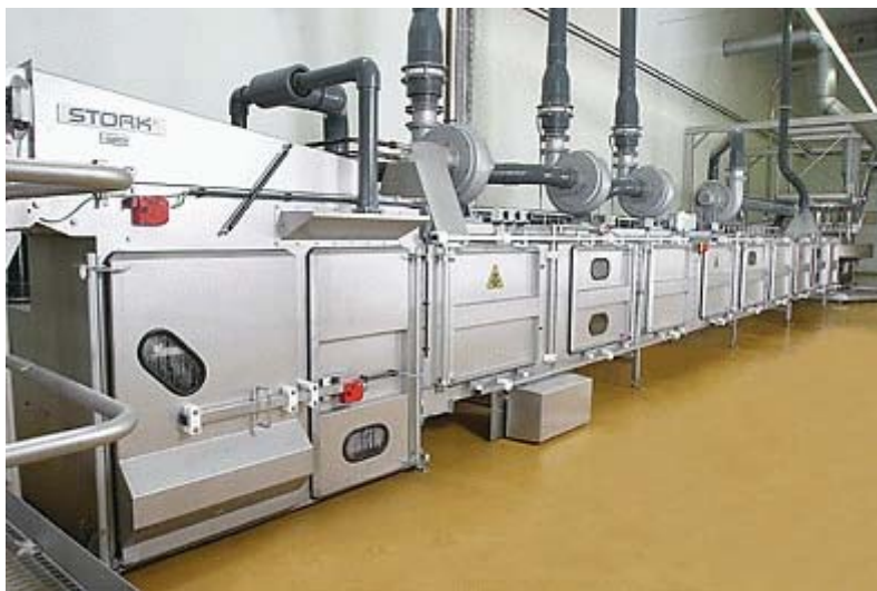
Figuur 3: CAS-installatie met \text{CO}_2/\text{O}_2 in twee stappen. De kippen worden eerst in het bovenste deel met lage \text{CO}_2 -concentratie (20% tot 40%) verdoofd en in het onderste deel met een hoge \text{CO}_2 -concentratie (60% tot 80%) irreversibel verdoofd. Foto gebruikt met permissie van Stork BV.
