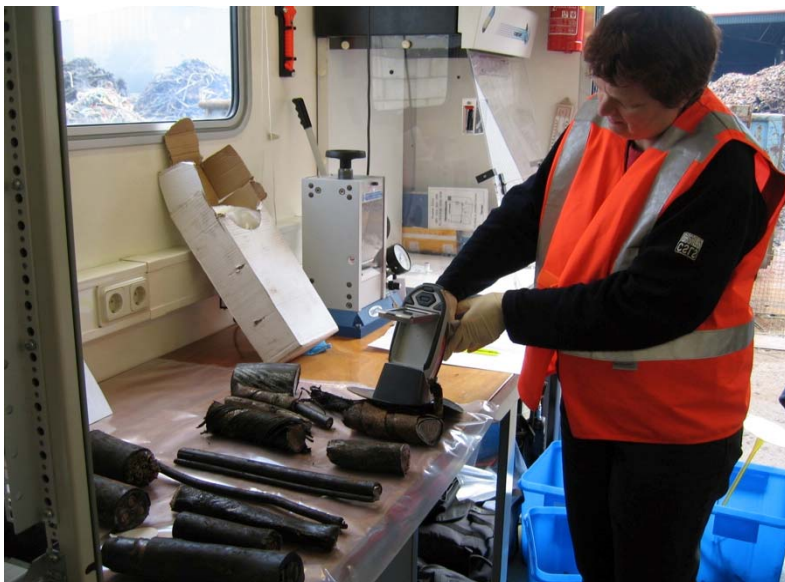
Figuur 3: De analist meet met een handheld XRF-meetapparaat de totaalgehalten aan elementen in de kabelomhulling (Bron: RIVM-briefrapport 609021097)
