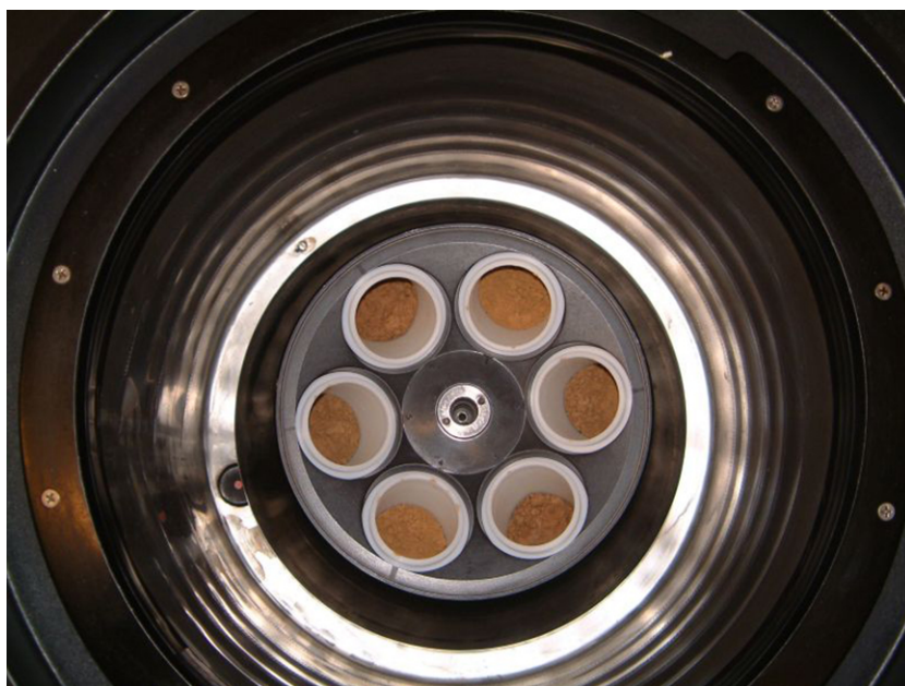
Figuur 7.1 Vochtextractie door het centrifugeren van bodemmonsters
