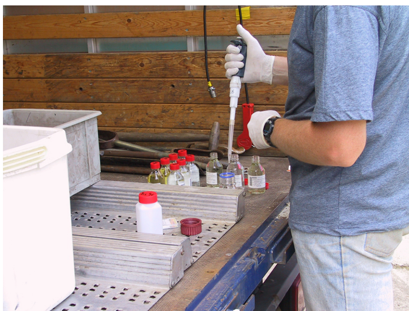
Figuur 6.1 Aanzuring van de grondwatermonsters in het veld als onderdeel van de conservering (= filtreren en aanzuren)
