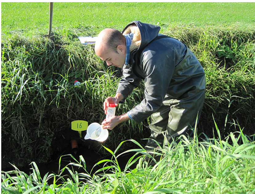
Figuur 9.1 Monsternamname van een drain (oranje buis bij nr.16). Het via een maatbeker opgevangen drainwater wordt bewaard in een monsternamnameflesje
