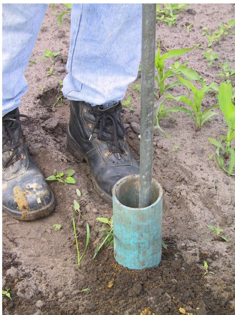
Figuur 5.1 Toepassing van een kraag (de blauwe buis) tijdens het boren
