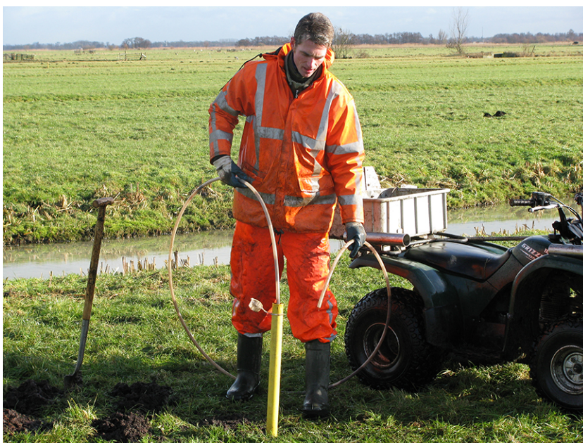
Figuur 8.1 Verwijdering van bezinsel en toegestroomd water uit de reservoirbuis (gele buis) op de dag van plaatsing
