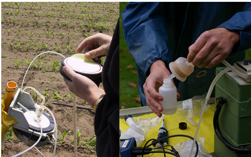
Figuur 11.1 Het vervangbare cellulose-nitraat membraanfilter (links) en een in-line filter (rechts)
