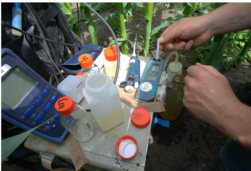
Figuur 10.1 Meting van de verkleuring van het teststrookje in de Nitrachek
