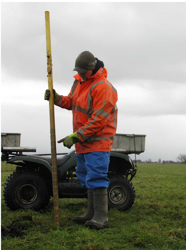
Figuur 4.1 De reservoirbuis waarvan het filter is geperforeerd met spleten (filterspleetbreedte 0,4 mm)
