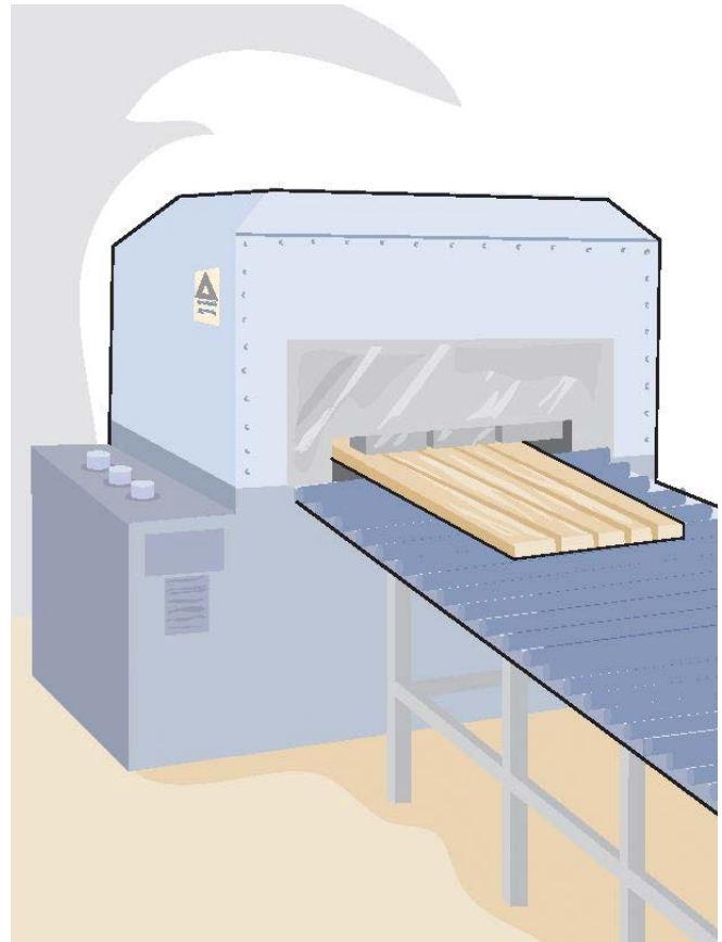
Illustratie van een machine voor radiofrequent drogen van verlijmd hout (illustratie: Gunilla Guldbbrand).
