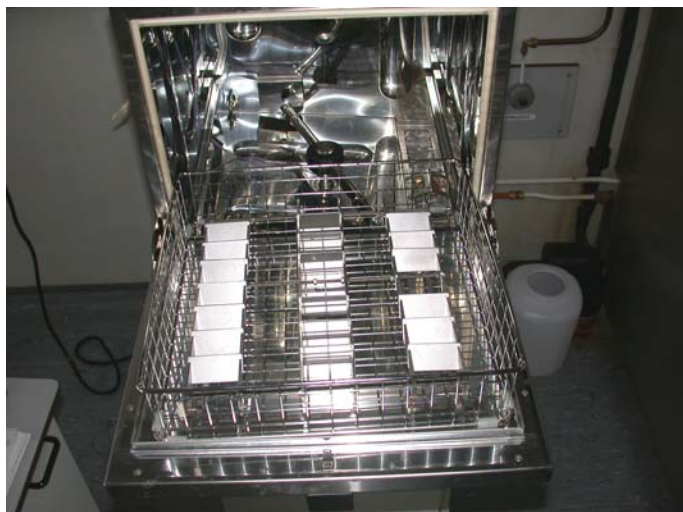
Figuur 1. Positie van testplaatjes in de wasmachine
