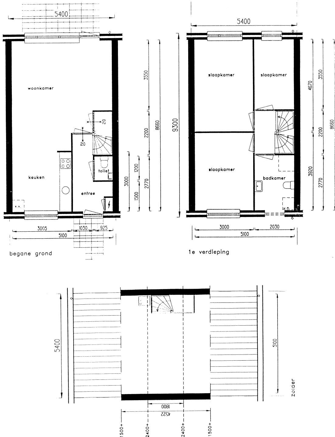
Figuur 1 Schematische weergave van de referentie tussenwoning, zoals die is gehanteerd in dit rapport. De aangegeven maten zijn in mm. Ten behoeve van de dosisberekeningen is het gehele huis gemodelleerd, dosistempi zijn slechts berekend voor de begane grond en eerste verdieping, in beide gevallen op 1 meter boven het vloeroppervlak.
