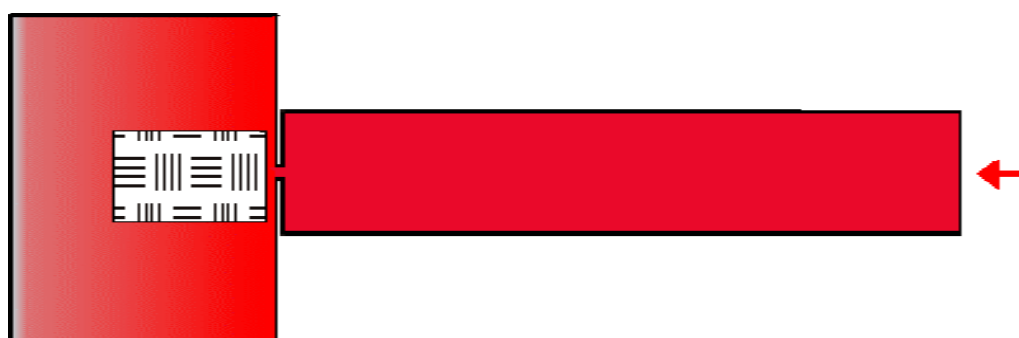
Figuur 2.c. Capsule volume te groot.
