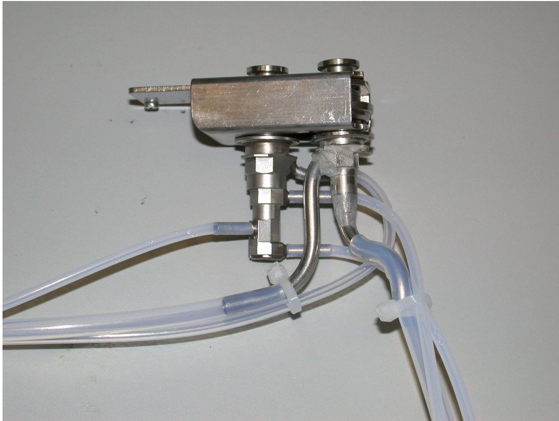
Foto 18 Samenbouwen van de ventielcilinders en de slangen tot een stevig geheel mbv tiewraps.
