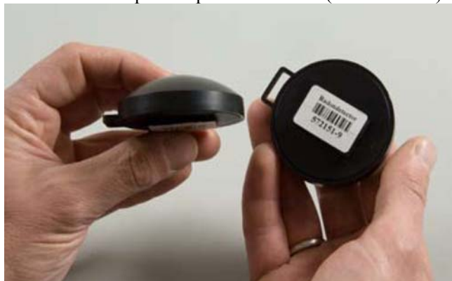
Figuur 1 Onder- en zijaanzicht van de in de survey toegepaste radondetector (Gammadata)
