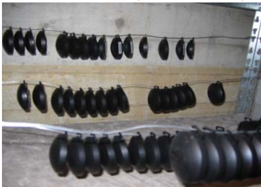
Figuur 8 Meting van het effect van thoron ( ^{220}\text{Rn} ) met radondetectoren op verschillende afstanden van muur.
