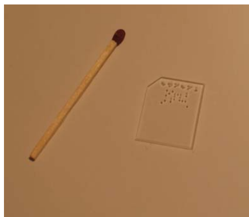
Figuur 2 De in de radondetector toegepaste (transparante) film met referentienummer
