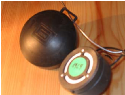
Figuur 7 Radondetectoren van Gammadata (links) en FzK (rechts) naast elkaar.
