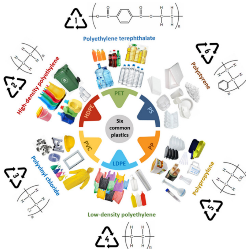
Figuur 1.1 Veelvoorkomende polymeren in kunststoffen met hun recyclingcodes en chemische structuren (Chang, 2023).
