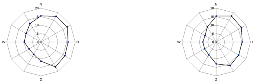
Figuur 9. Gemiddelde concentraties \text{NO}_2 (in \mu\text{g m}^{-3} ) op de meetpunt LC1 (links) en LC2 (rechts)
