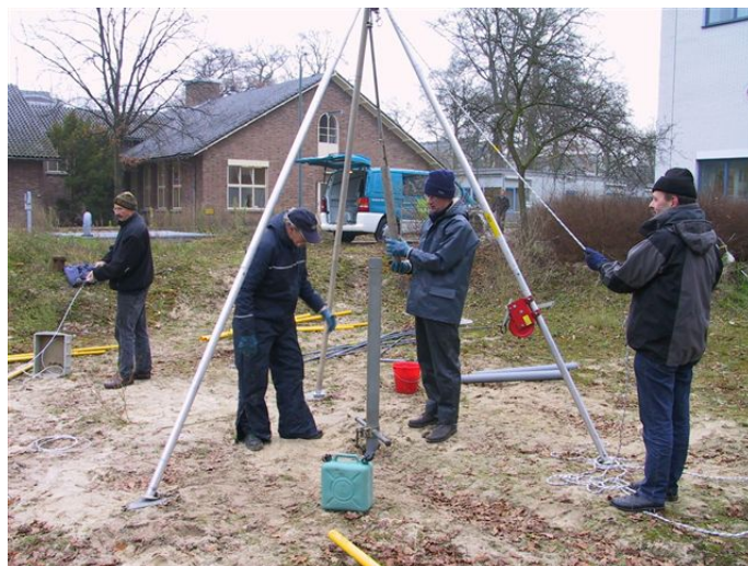
Figuur 12 De pulsmethode in gebruik op het RIVM terrein
