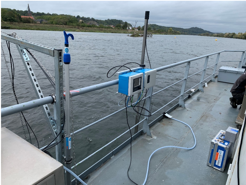
Foto 2 Uitzicht vanuit het meetponton van Rijkswaterstaat. De sensoren buiten zijn aan de reling bevestigd. De blauwe kastjes zijn de controllers van de Viomax
